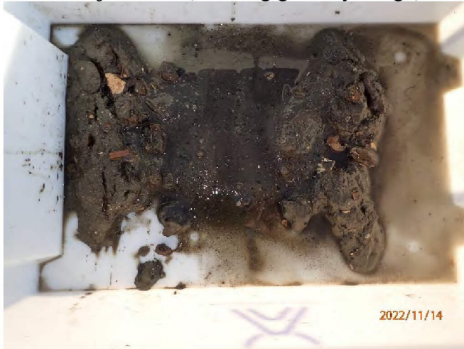
Prøvestasjon 5: Silt, sand og grus. Lys farge, luktfri prøve med fast konsistens.
