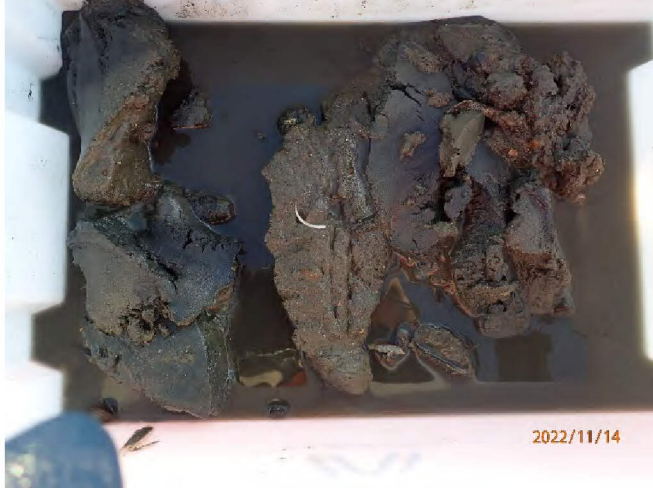
Prøvestasjon 4: Silt og leire. Lys farge, luktfri prøve med mjuk konsistens.
