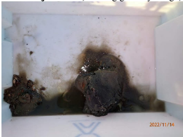
Prøvestasjon 6: Silt, sand og grus. Lys farge, luktfri prøve med fast konsistens. To prøver
