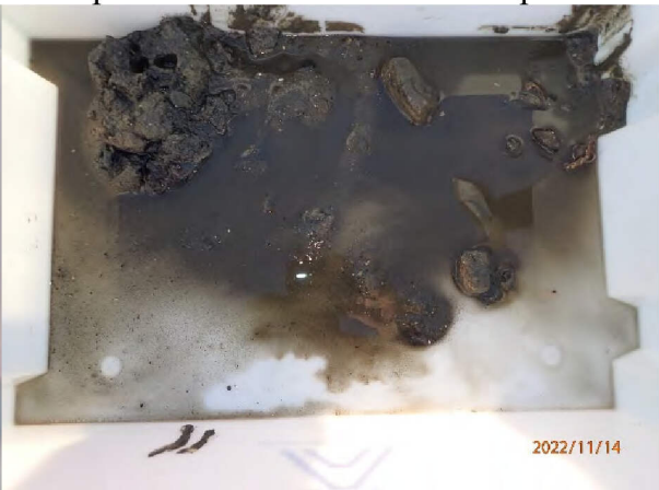
Prøvestasjon 6: Silt, sand og grus. Lys farge, luktfri prøve med fast konsistens. To prøver
