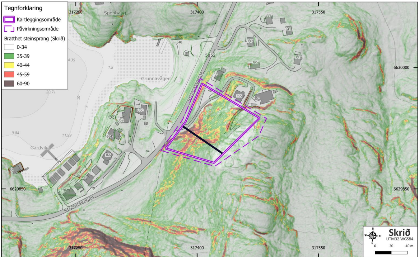
Figur 7 Helningskart utarbeidet av Skrið for steinsprang viser areal i påvirkningsområdet hvor helning angir potensiell kritisk bratthet for utløsning av steinsprang (over 45°). Sort linje viser terrengprofil i Figur 6. Kartleggingsområdet i lilla omriss. Kilder Skrið og Kartverket, 2026b
