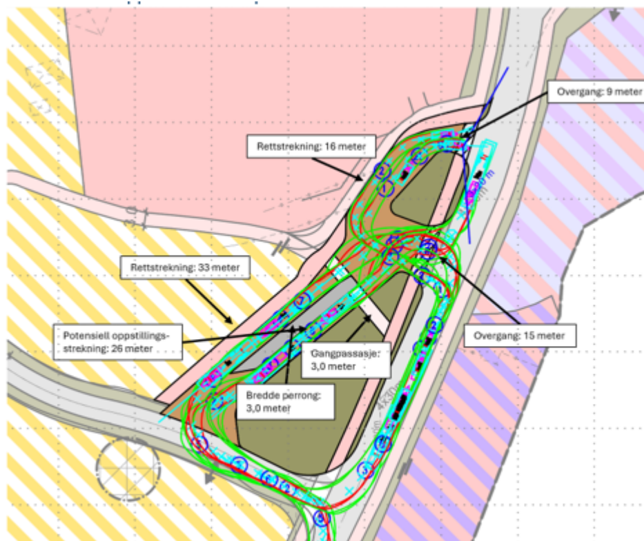
Figur 13 Illustrasjon av sporing på kollektivhaldeplassen.
