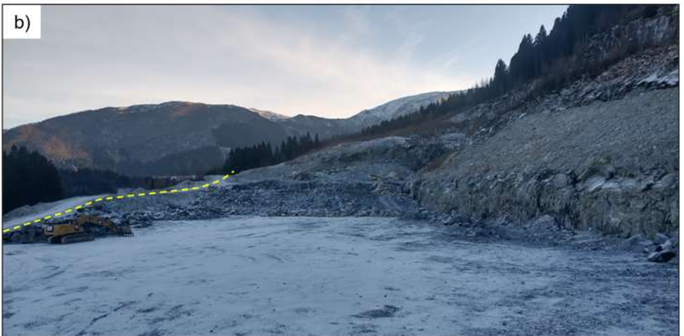
Figur 27 Oversikt over steinbrudd lokalisert like sør av vurdert areal fra a) øst mot vest og b) vest mot øst. Steinbruddet dekker et betydelig areal og fremstår med tilnærmet flat bunn samt en betydelig forhøyning angitt ved etablert anleggsvei i nordlig retning. Forhøyningen avgrenser steinbruddet fra vurdert areal lokalisert videre i nordlig retning. Det fremstår usannsynlig at skredhendelser utløst sør av steinbrudd skal forsere dette og utgjøre en risiko for vurdert areal.
