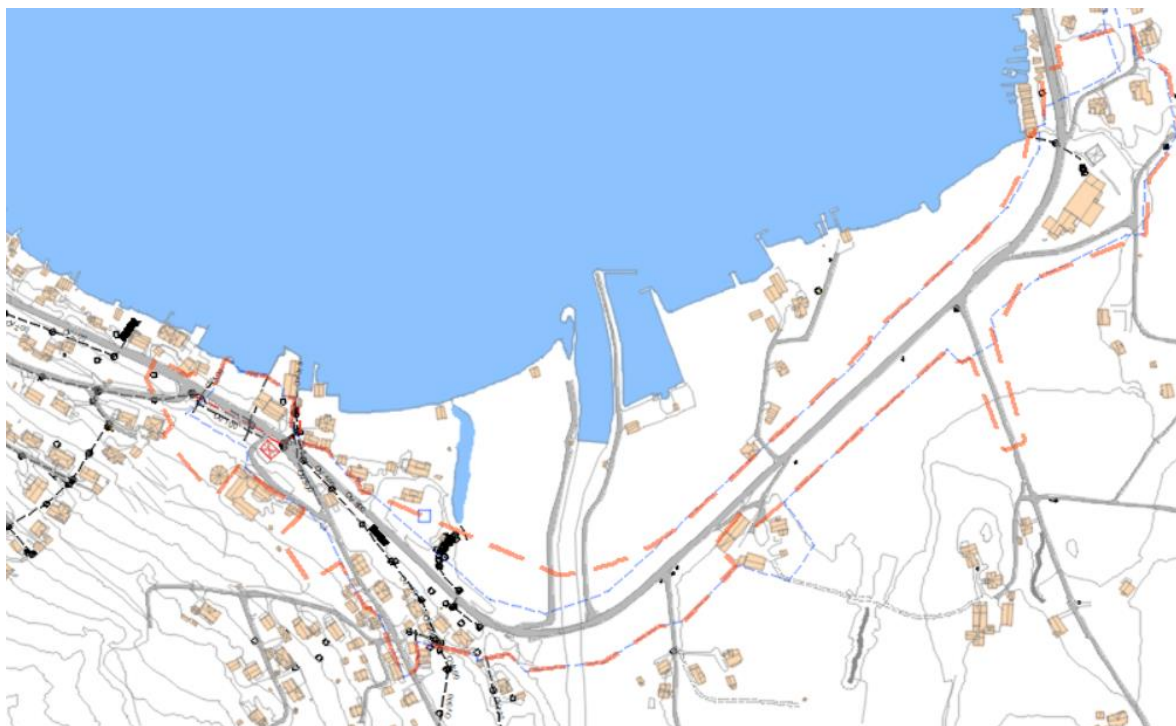
Figur 6: Det eksisterande overvassnett, som består av overvassleidningar. I vest er det Ø100-500, mens i aust ved Best stasjonen er det Ø800. Planområdet er markert med raud stripe.
