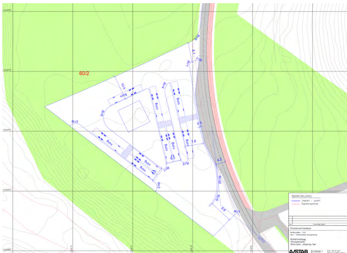
Figur 37 Illustrasjon av kollektivanlegg for buss (A/STAB)
