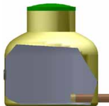
3. Aquaflush mekanisk støtbelaster (lavtrykk).
